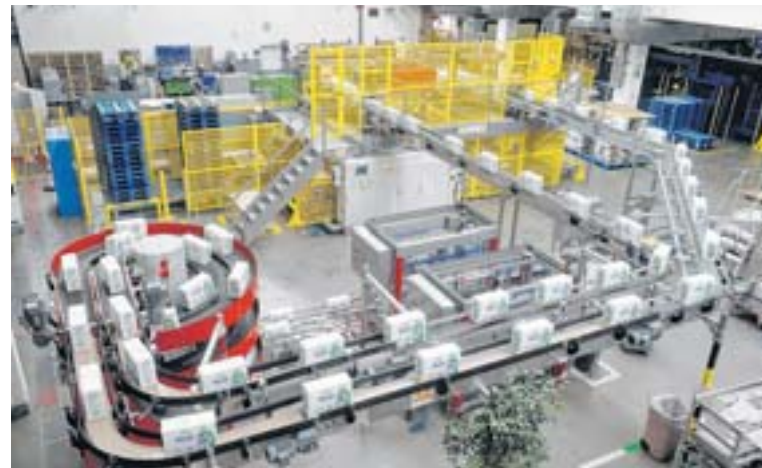
Auf Förderbändern werden die Kartons mit den Waschmittelflaschen zur auto-matischen Packstation mit Europaletten befördert. Die Paletten wiederum wer-den wie von Geisterhand zum Lkw befördert.
